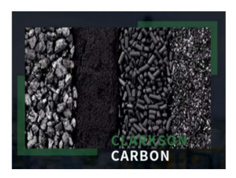
活性炭是一种既传统又现代的材料,由于其独特的孔隙结构和表面官能团,活性炭具有化学稳定性、比表面积、机械强度及良的耐酸、耐碱和耐热的性能。椰壳是制造活性炭的较好原料,因为椰壳具有良的天然结构,易于形成发达的微孔结构,从而形成巨大的有效吸附表面积,经研究表明,每克椰壳活性炭大约有500~1500m2的表面积。用纯椰壳制造的活性炭富有高纤维、高密度、毛细孔分配均匀和吸附力强等点,较适于废气和净水处理,价廉物美,在国际市场上十分\*\*。
